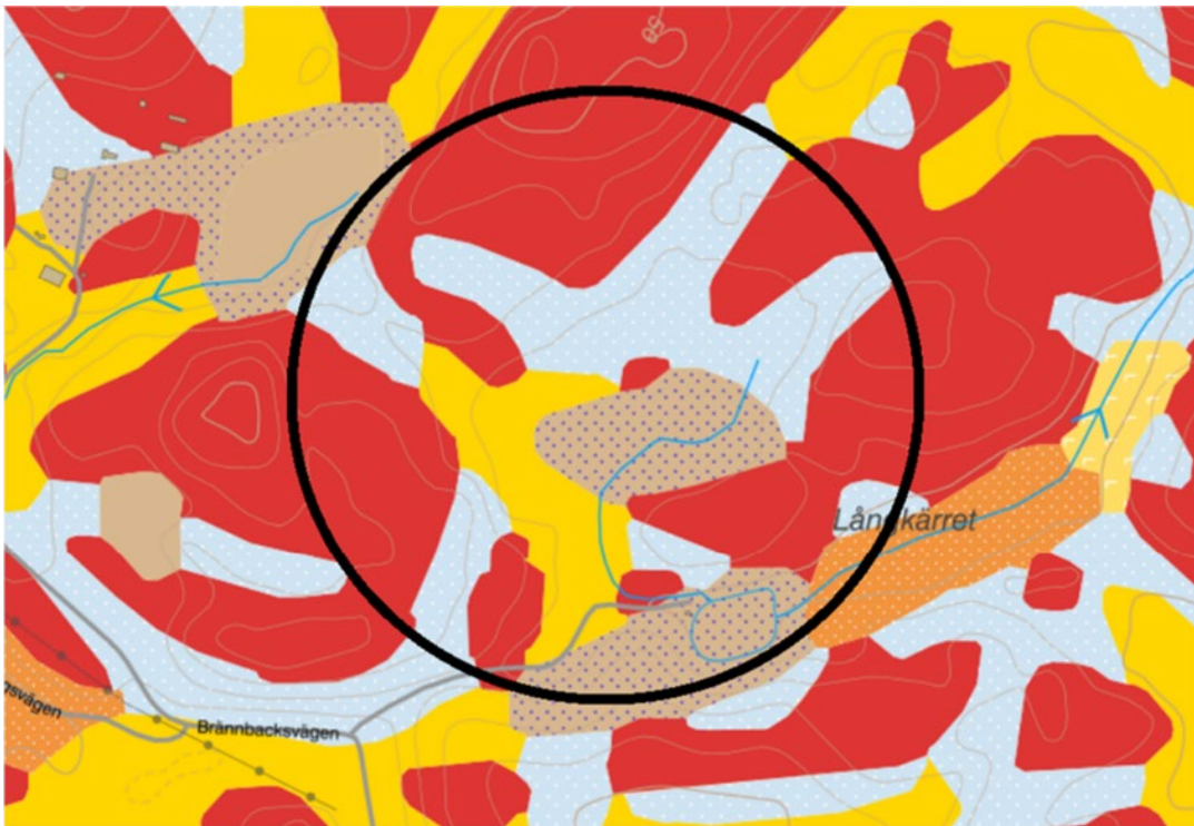
Figur 4. Jordartskartan, Sveriges geologiska undersökning (SGU), (Structor Geoteknik, 2023). Berg i dagen markeras med röd färg, sandig morän markeras med ljusblå färg, kärrtorv markeras med beige färg med raster och glacial lera markeras med gul färg.
